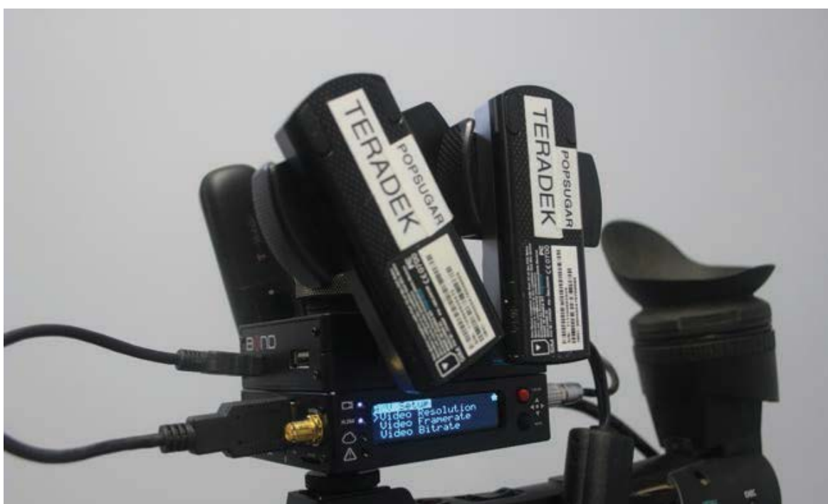
Obr. 3 Teradek Bond 4G-agregátor umiestnený na vrchole Teradek Cube
