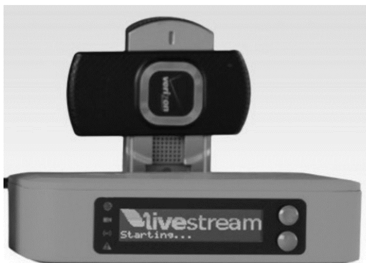
Obr. 2 4G-modem firmy Verizon, špičkové zariadenie pre živé vysielanie s použitím kamerového kódéra
