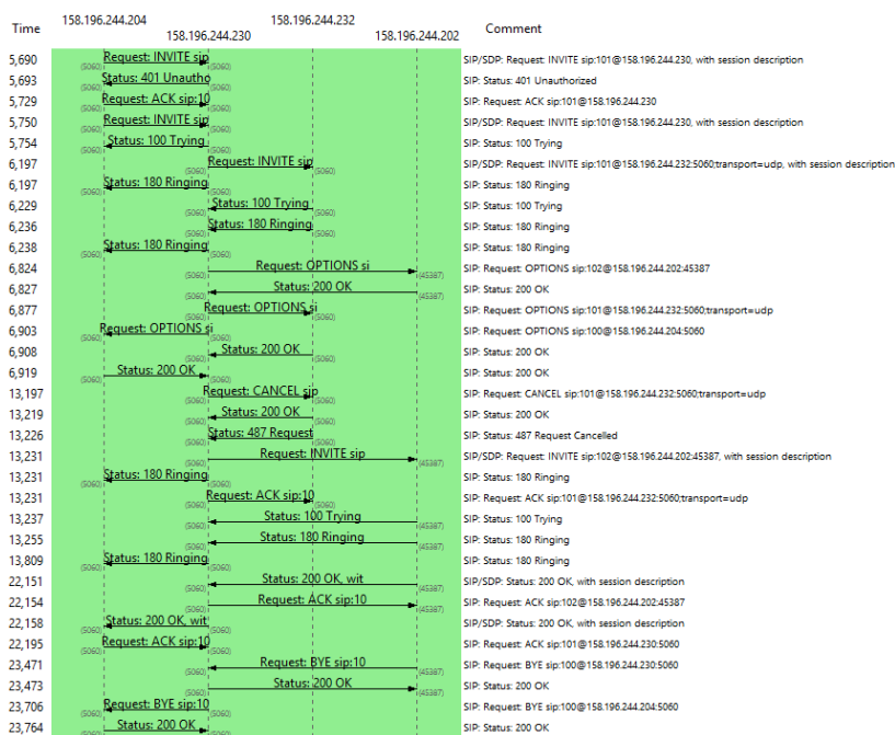
Obr. 20.1 Grafické zobrazení toku zpráv v SIPu.
