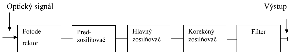
Obr.1 Všeobecná bloková schéma optického prijímača
